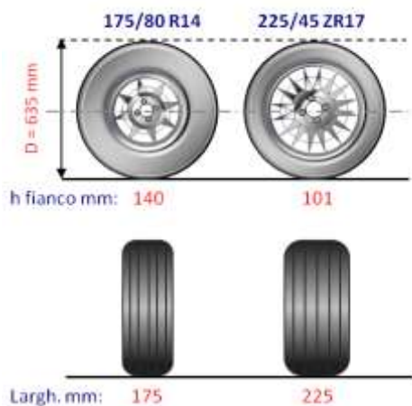
Figura 16. "RAPPORTO D'ASPETTO". Gli pneumatici a sezione ribassata, a parità di diametro esterno, sono più larghi, hanno un cerchio più ampio e il fianco più basso rispetto a quelli "tradizionali".
